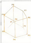
Figura 8 - La penna e l'indicatore puntano due vertici di un lato superiore (punti P1-P5), la penna punta (punti P6-P8) e i segmenti che li collegano (P1-P6, P2-P7, ecc.).
